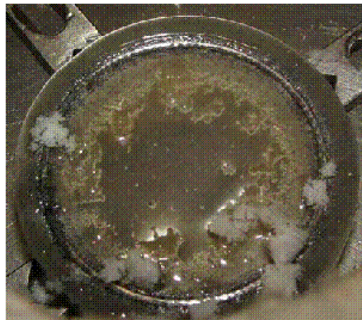
Figura 3.43. Probeta de aluminio tras el ensayo lubricado con L108 y condensación de agua (0,15 ms -1 ; -30 °C; 2,45 N; 180 m).
